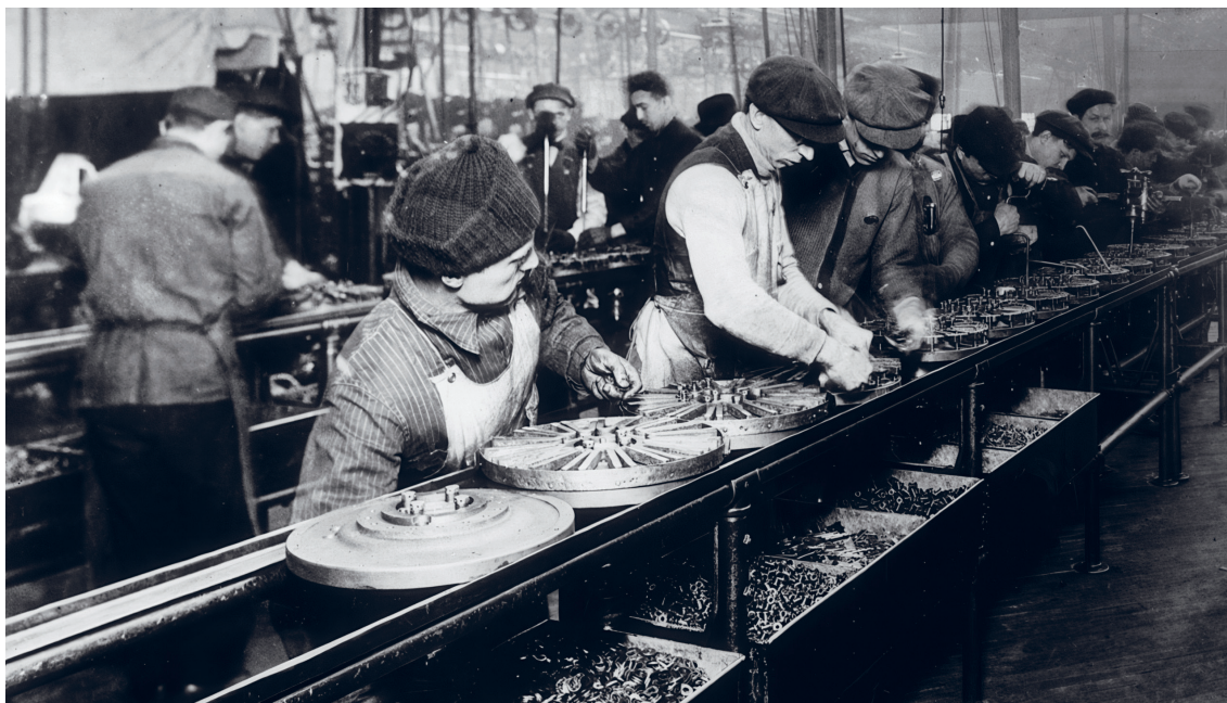
Fábrica da Ford. Trabalhadores da linha de montagem de volantes e magnetos de ignição para automóveis no Modelo Ford T. Highland Park C. Michigan, EUA, 1913.
