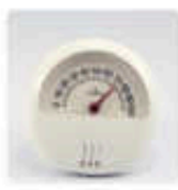
Higrômetro Mede a umidade relativa do ar
