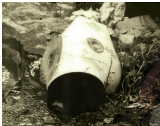
Cabeçote da bomba que continha a cápsula com o césio-137 do acidente radioativo ocorrido em Goiânia (GO), em 1987.
